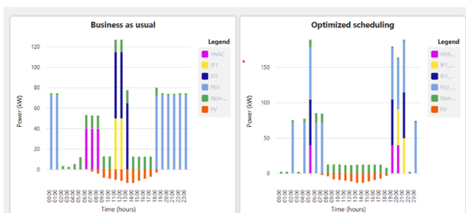
Slika 3 - Raspodjela opterećenja u uobičajenom (lijevo) i optimizovanom (desno) načinu rada
