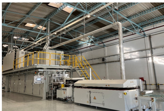
Slika 2 - Električna peć (lijevo), TAB s električnim grijačima (desno)
