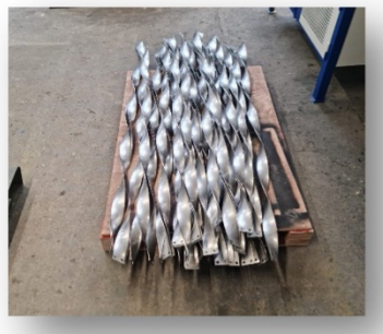
Slika 4 -Turbulatori (lijevo), ugradnja turbulatora u TAB (desno)
